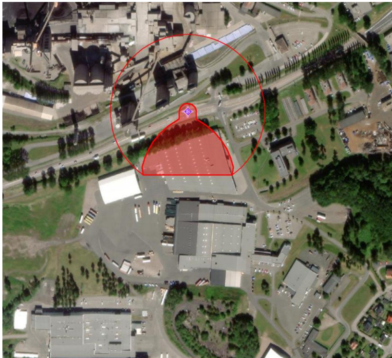
Figur 21. Konsekvensområde där 60% LEL är markerat inom rött område och röd linje motsvarar konfidenslinje för vindriktning.
