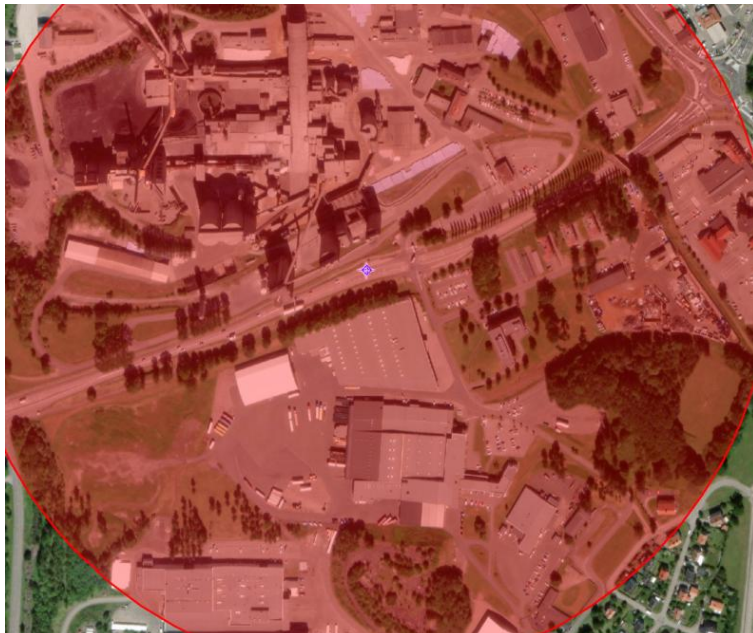
Figur 22. Konsekvensområde där risk för att personer avlider inom 60 sekunder är markerad med rött område. Aktuell brand pågår i 15 sekunder.
