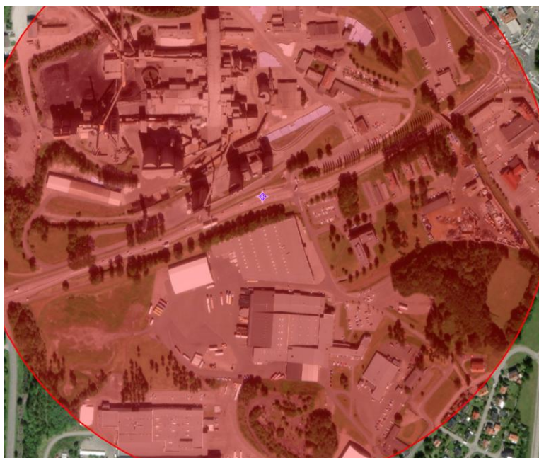
Figur 23. Konsekvensområde där risk för att personer avlider inom 60 sekunder är markerad med rött område. Aktuell brand pågår i 15 sekunder.
