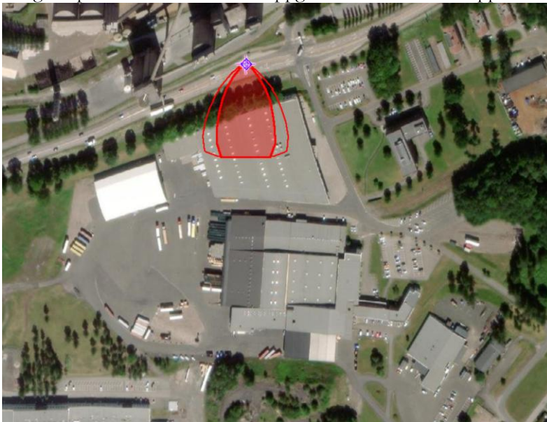
Figur 24. Konsekvensområde där 60% LEL är markerat inom rött område och röd linje motsvarar konfidenslinje för vindriktning.
