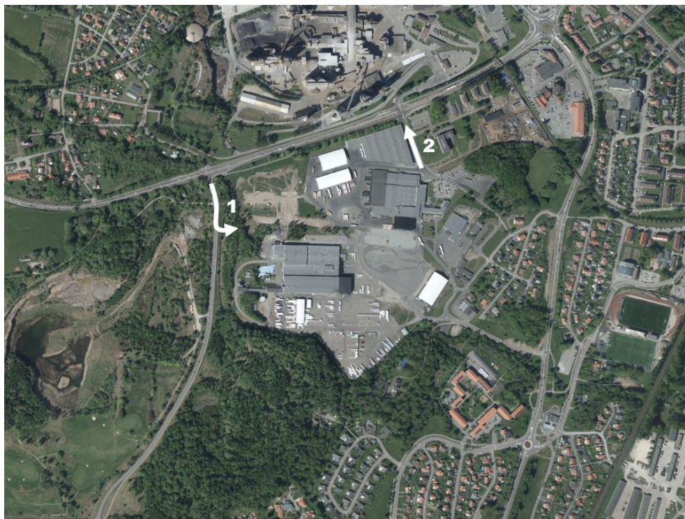
Figur 14. Studerade åtgärdsförslag i form av ny infart till fastigheten Stenullen 3 via Simsjövägen (1) tillsammans med att behålla utfarten via Gruvgatan (2). (Bildkälla NVDB.se).
